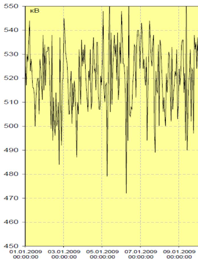
Рисунок 2. График изменения напряжения на ПС 500 кВ Агадырь до установки УШР
