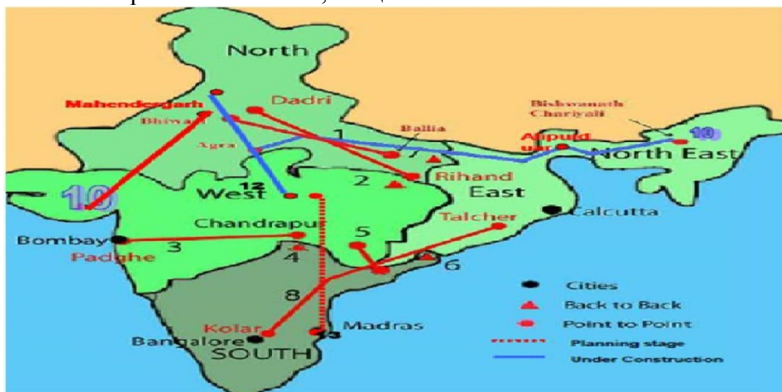
Рисунок 2 - Схема ЛЭП постоянного тока в Индии.
