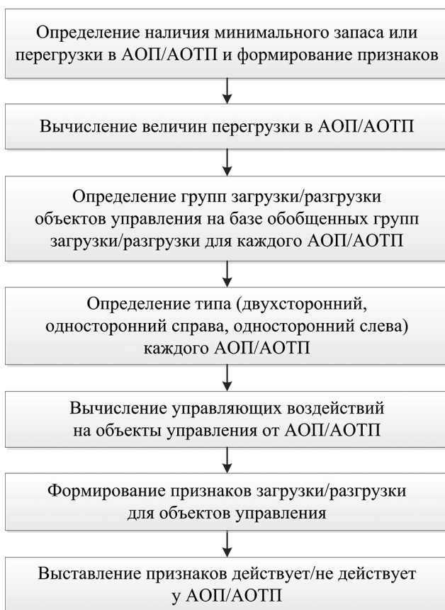
Рис. 2. Структурная схема алгоритма работы АОП/АОТП
