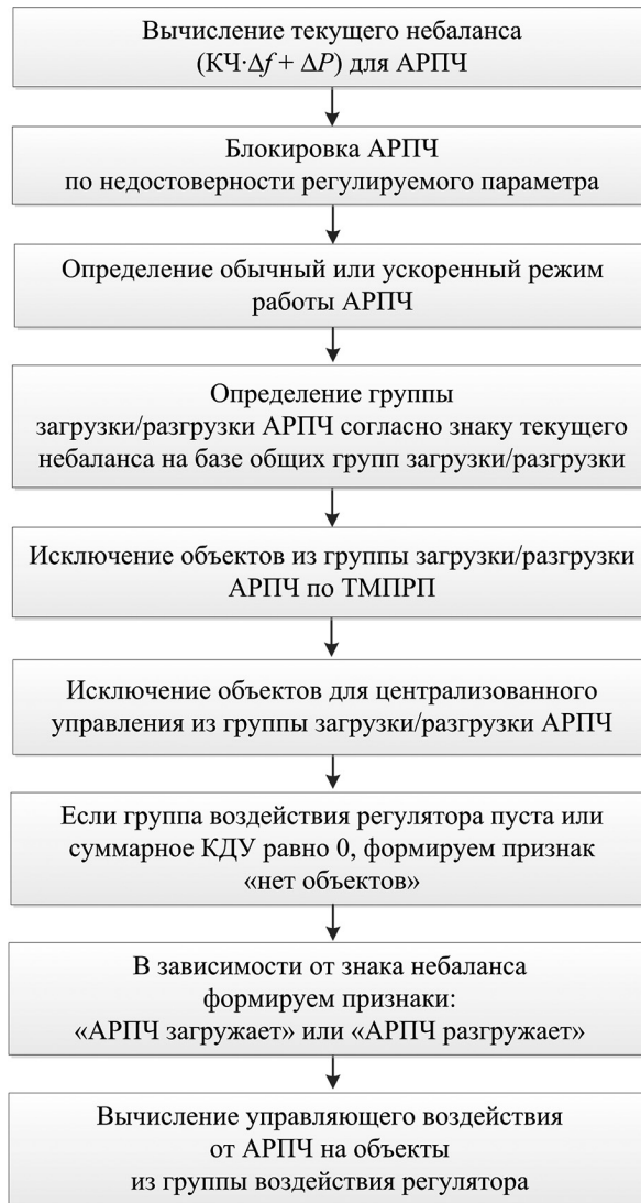
Рис. 1. Структурная схема алгоритма работы АРПЧ
