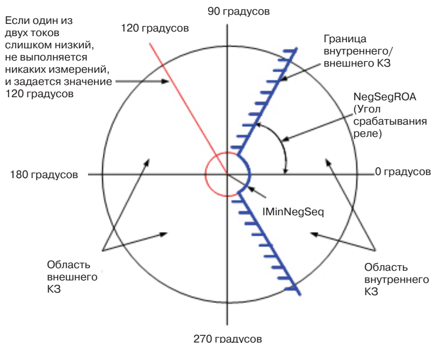
Рис. 3: Характеристика срабатывания селектора внутренних/внешних повреждений
