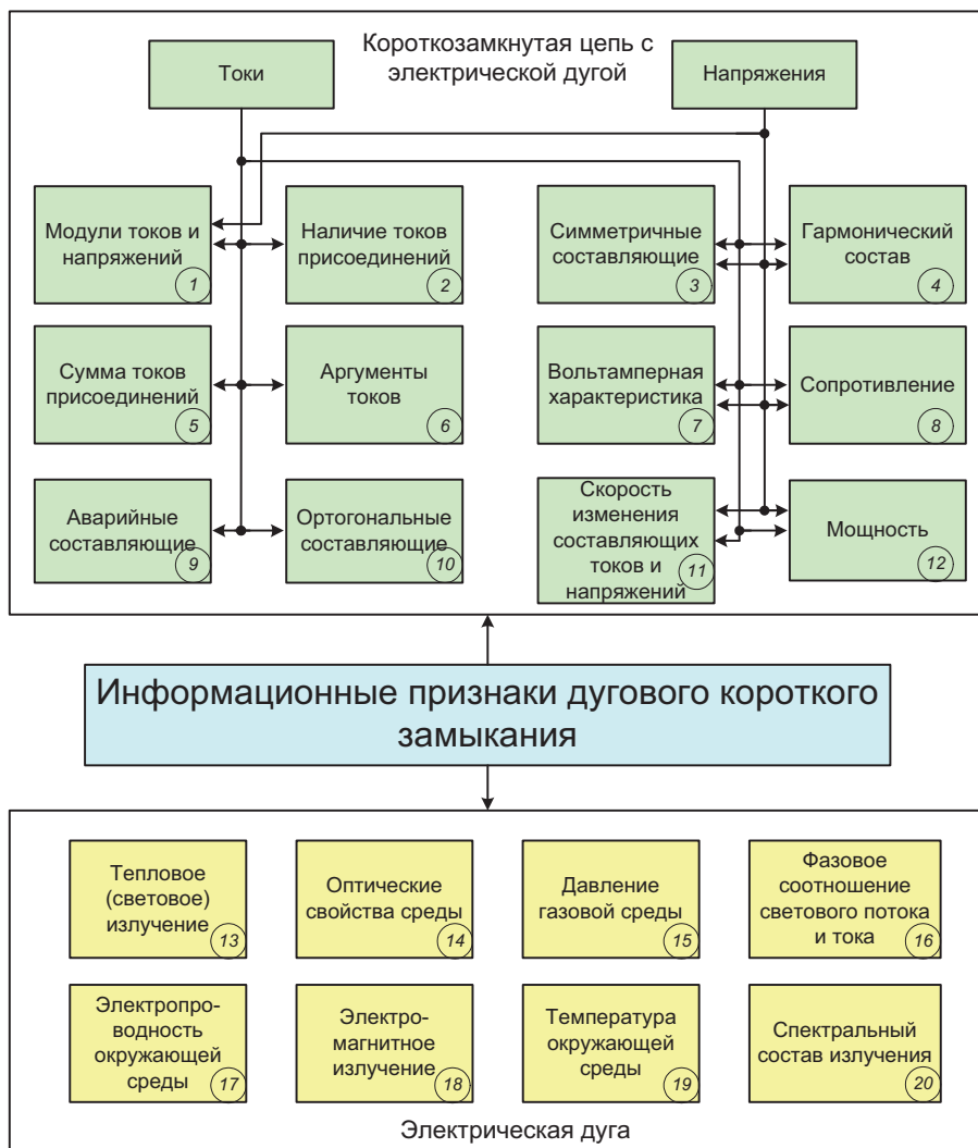
Рис. 1: Информационные признаки дуговых коротких замыканий в КРУ
