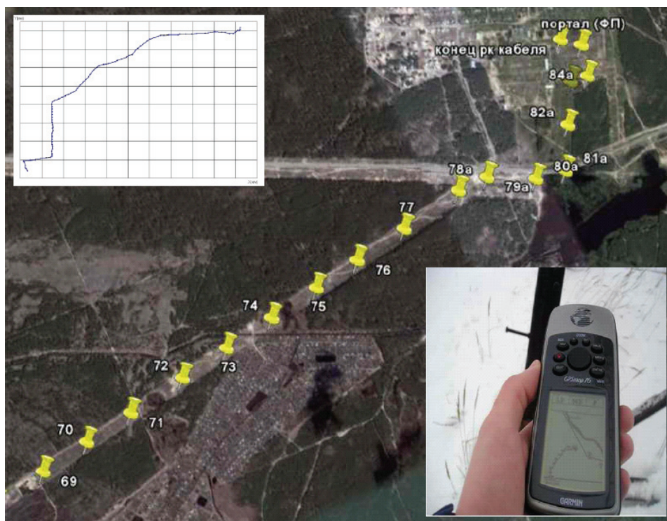
Рис. 4: Уточненная трасса исследуемой ЛЭП
