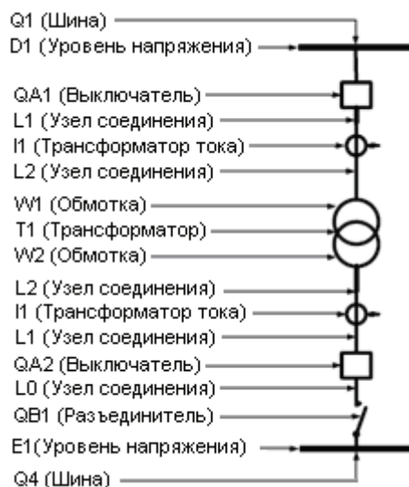
Рис. 1: Пример участка схемы подстанции
