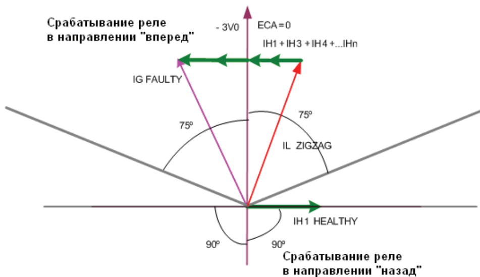
Рис. 5: Диаграмма при замыкании фазы на землю для поврежденного и неповрежденного присоединений и характеристика направления, рекомендуемая для функции 67N
