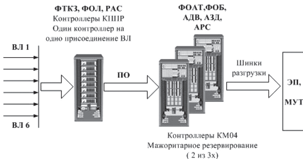
Рис. 4. Состав и структура связей по аварийному тракту АЭЗ с распределенным оборудованием по присоединениям ВЛ и дополнительными функциями
