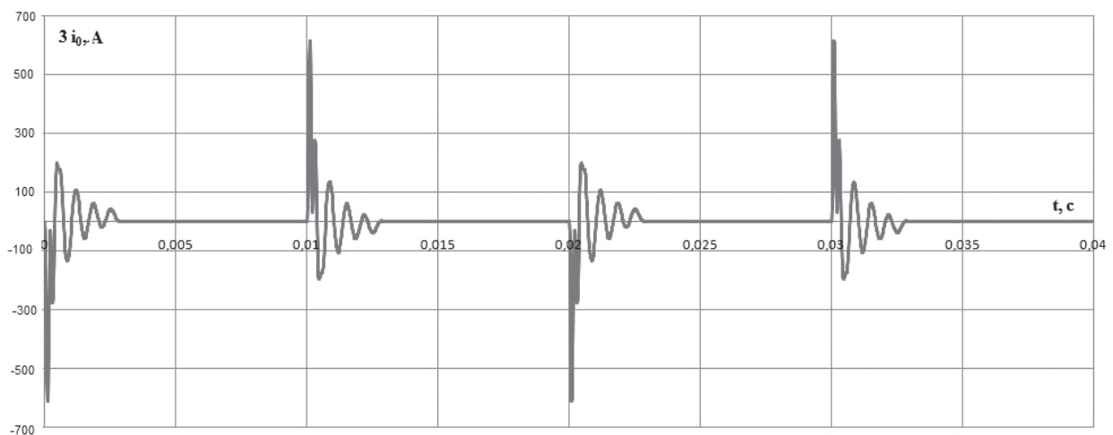
Рис. 2. Пример тестового сигнала для исследования динамических режимов функционирования ТЗНП — дуговое перемежающееся ОЗЗ по модели Петерсена
