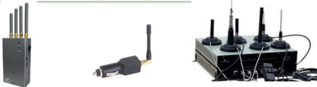
Рис.2. Источники помех, воздействующие на аппаратуру ГНСС
