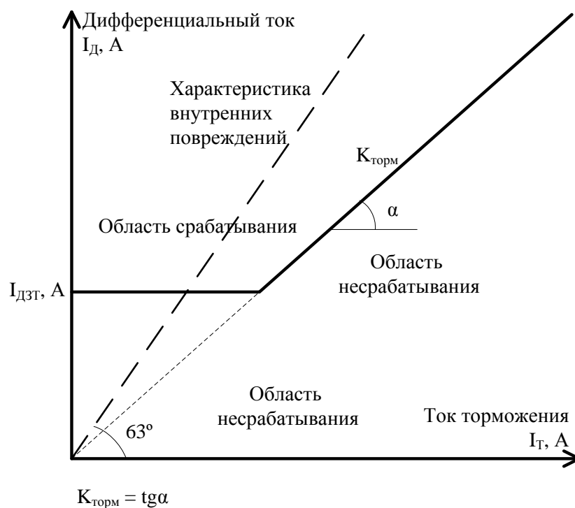
Рис. 1. - Характеристика срабатывания ДЗТ
