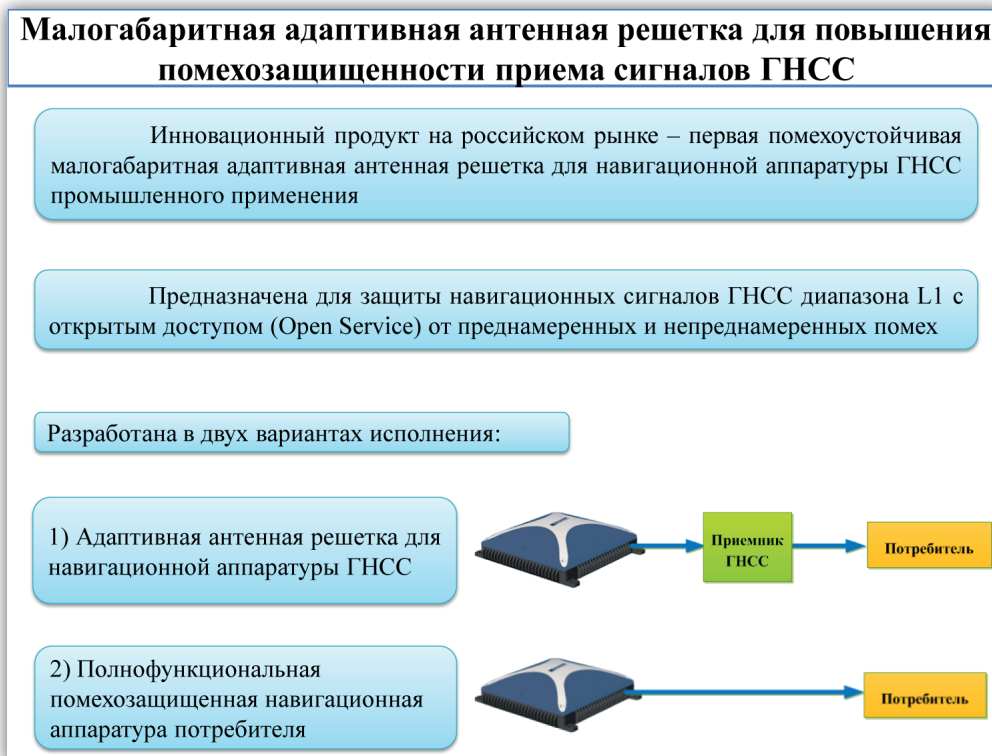
Рис. 7. Малогабаритная адаптивная антенная решетка разработки ОАО «ВНИИР-Прогресс»
